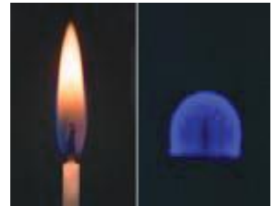
Figura 4 - À esquerda temos uma vela queimando sob o efeito da gravidade terrestre, exibindo um formato alongado e diferentes tonalidades em sua chama. À direita temos uma imagem de uma vela queimando em um ambiente de microgravidade (na ISS) mostrando a alteração no formato e cor da chama devido à mudança no processo de transporte de gases para a combustão [10].
