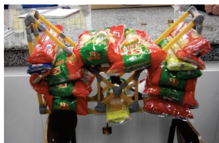
Figura 5 - Testes da resistência da ponte.
