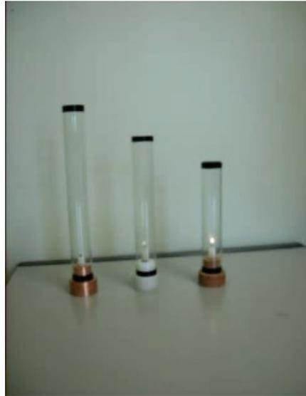
Figura 2 - Observação da influência da altura do tubo no funcionamento da vela.
