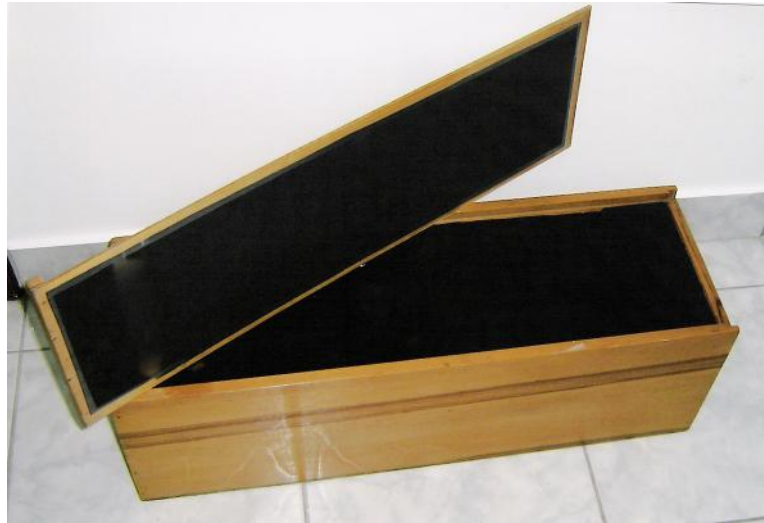
Figura 9 - Imagem da caixa e sua tampa com as faces internas revestidas com papel camurça preto.
