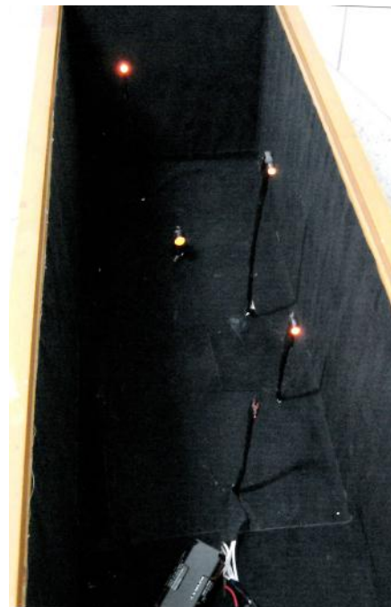
Figura 10 - Hastes revestidas com papel preto e com LEDs nas extremidades superiores. Todos foram ligados a uma bateria de 3,0 V.
