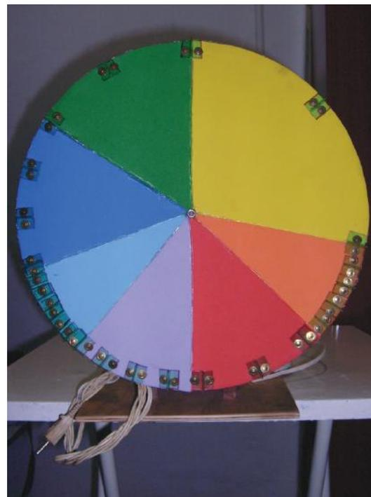
Figura 2 - disco de Newton fixado ao motor.
