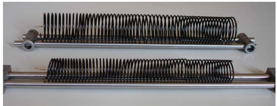
Figura 3. Foto das molas empregadas nos ensaios descritos a seguir. Pequenos anéis confeccionados com fio de cobre bastante fino foram adicionados às duas extremidades das molas, de modo a fazer com que as cargas tivessem sempre a direção do eixo destas.
