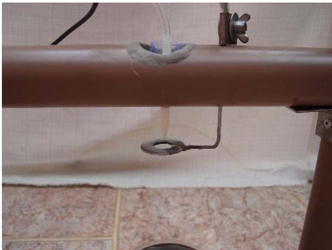
Figura 3. Gotejador e indutor de carga elétrica nas gotas.
