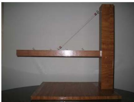
Figura 7 - Barra em equilíbrio: ponto de suspensão no meio.
