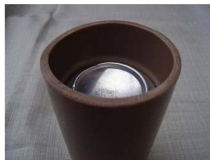
Figura 5. Recipiente coletor visto de baixo. O fundo da lata de alumínio fica no ar, sem entrar em contato com o solo.
