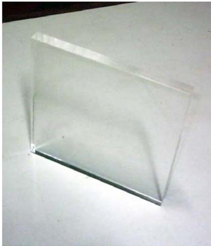
Figura 3. Placa de acrílico utilizada no experimento com dimensões  $200 \times 200 \times 15$  mm.
