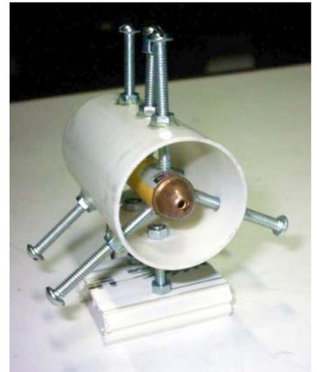
Figura 5. Chaveiro apontador laser centralizado em um tubo de PVC de 40 mm.
