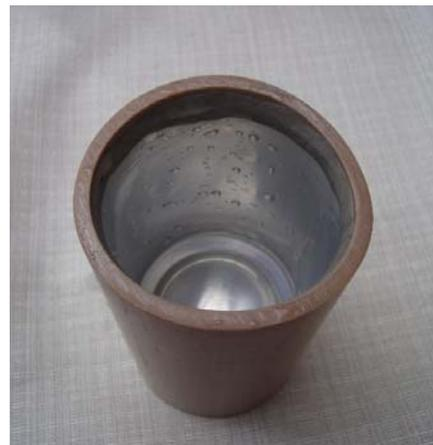
Figura 4. Recipiente coletor visto de cima. É composto por um cano de PVC, que é isolante elétrico, com uma lata de alumínio em seu interior.
