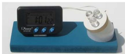
Figura 6. LEDs funcionando como célula fotovoltaica.
