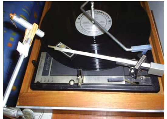
Figura 10. Toca-discos, uma ponteira laser e um pequeno espelho sobre a cápsula: o feixe refletido na parede vibra com o disco tocando, ilustrando opticamente a estrutura dos sulcos de gravação.
