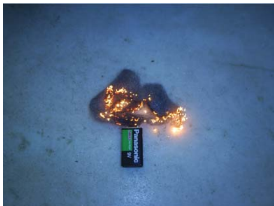
Figura 5. Um pedaço de palha de aço queimando devido à corrente elétrica gerada pela bateria.
