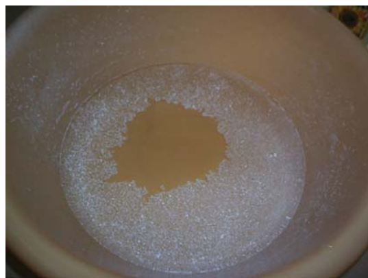
Figura 8. Partículas de talco deslocadas pela gota de óleo que se espalhou sobre a superfície da água. O diâmetro da área sem talco é de aproximadamente 20 cm. O diâmetro da gota de óleo era de 1 mm. Isso resulta em uma espessura da camada de 10 nm. Nada mal para uma tentativa improvisada rápida.
