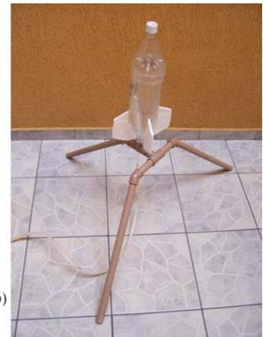
Figura 3. (a) As aletas devem ser fixadas simetricamente duas a duas. (b) Foguete pronto sobre a base de lançamento.
