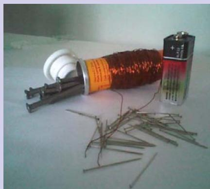
Figura 1. Montagem do eletroímã.
