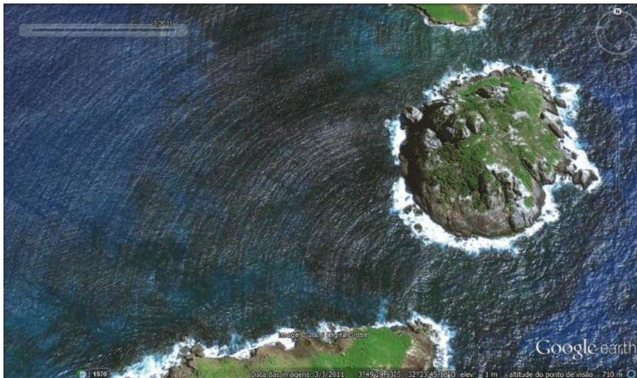
Figura 6. Difração de ondas através de abertura. Próximo a Fernando de Noronha. Coordenadas: 3°49'33.23" S 32°23'40.56" O.
