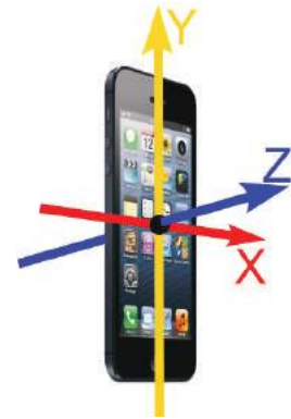
Figura 1. Orientação dos eixos que definem as componentes da aceleração de um tablet ou smartphone típico.
