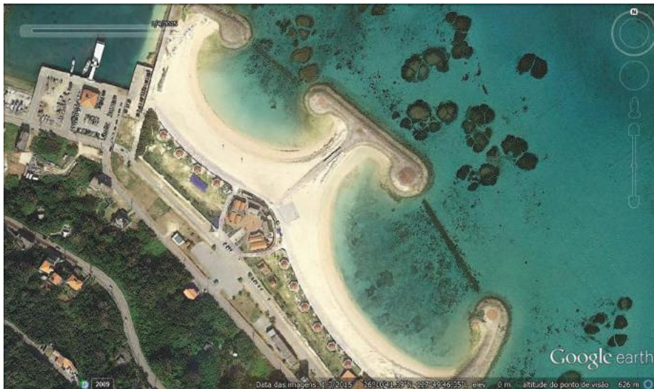
Figura 5. Difração de ondas através de aberturas. Okinawa, Japão. Coordenadas 26°10'41.10" N 127°49'45.28" L.
