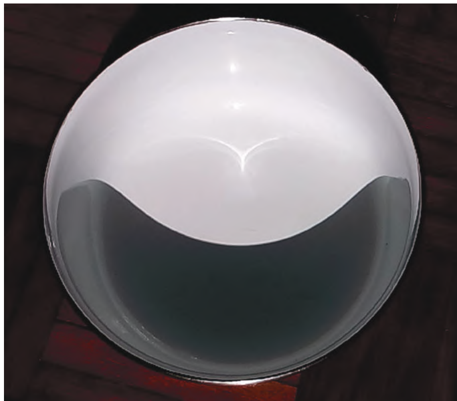
Figura 2. Cáustica de reflexão na superfície côncava interna de um recipiente cilíndrico exposto à incidência da luz solar, conforme sugestão da Ref. [10].
