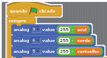
Figura 5. Blocos de programação no S4A para variar a intensidade de cada pastilha no LED RGB.
