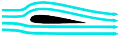
Figura 2. Representação muito comum do fluxo de ar por uma asa. A asa não tem qualquer sustentação.
