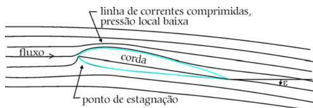
Figura 2. Linhas de corrente em torno do aerofólio NACA 2412.
