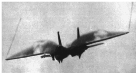
Figura 14. Condensação mostrando a distribuição de sustentação ao longo da asa (extraído de Patterns in the Sky , J.F. Campbell e J.R. Chambers, NASA, SP-514).
