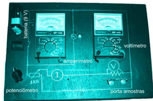
Figura 3. Conjunto completo com desenhos ilustrativos de cada componente para que haja a imediata associação entre o dispositivo em si e sua representação em um esquema que descreve o circuito. Nosso protótipo foi montado em uma base de madeira de 30 \times 15 cm, mas nada impede que seja usado outro tipo de material.
