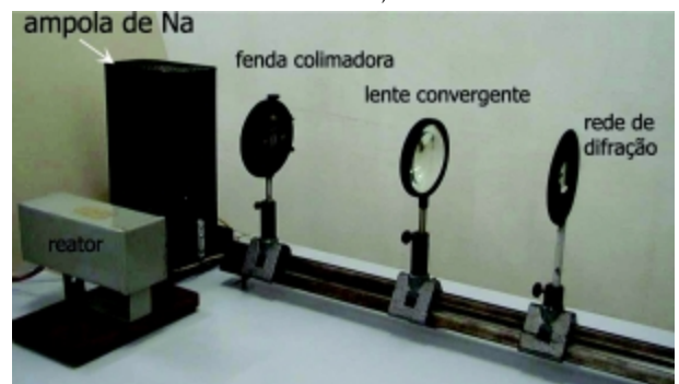
Figura 13. Montagem utilizada para a observação do espectro de absorção do Na.
