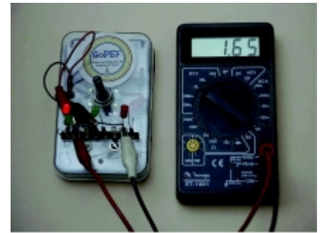
Figura 18a. O visor do voltímetro indica o valor de tensão necessária para o LED vermelho acender (1,65 V).
