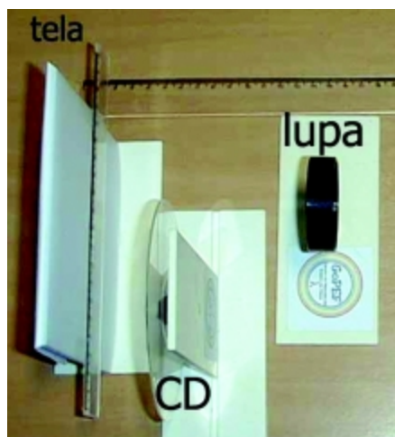
Figura 5. O CD disposto entre a lupa e a tela para a decomposição espectral.
