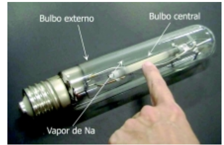
Figura 12. Lâmpada utilizada para a observação do fenômeno de absorção no vapor de Na.
