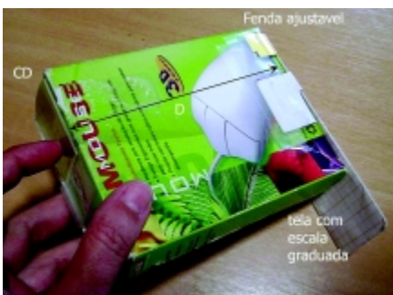
Figura 9. Espectroscópio manual segundo Cavalcante e Tavoraro [16].
