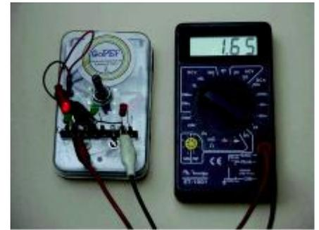
Figura 18a. O visor do voltímetro indica o valor de tensão necessária para o LED vermelho acender (1,65 V).
