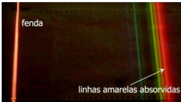
Figura 15a. Espectro observado transcorrido cerca de 3 minutos em que a lâmpada foi ligada.
