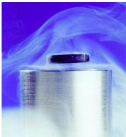
Uma pastilha no estado supercondutor levita acima de uma bobina ao ser repelida pelo campo magnético gerado pela bobina. A supercondutividade é um fenômeno coletivo dos elétrons no ambiente da rede cristalina.
