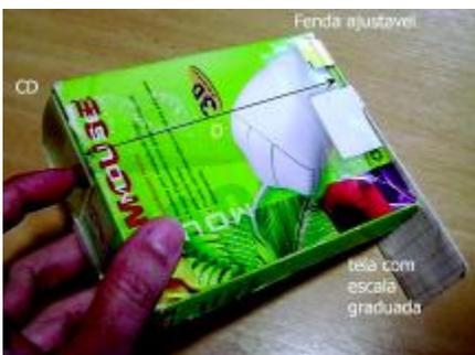
Figura 9. Espectroscópio manual segundo Cavalcante e Tavoraro [16].
