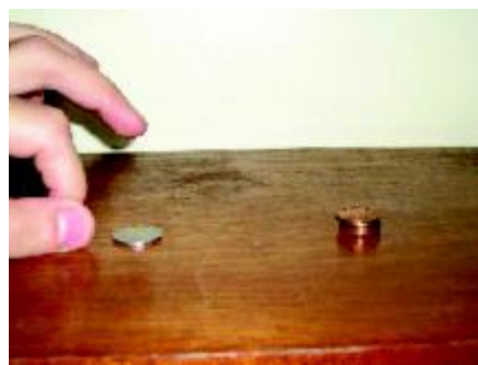
Figura 1. Montagem e procedimento. A mão está prestes a dar um “peteleco” na moeda da esquerda (o “projétil”); à direita, a pilha de moedas.
