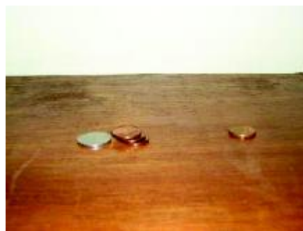
Figura 2. A moeda projétil pára após o choque e a moeda “alvo” recebe “quantidade de movimento”, afastando-se. As demais moedas caem verticalmente.
