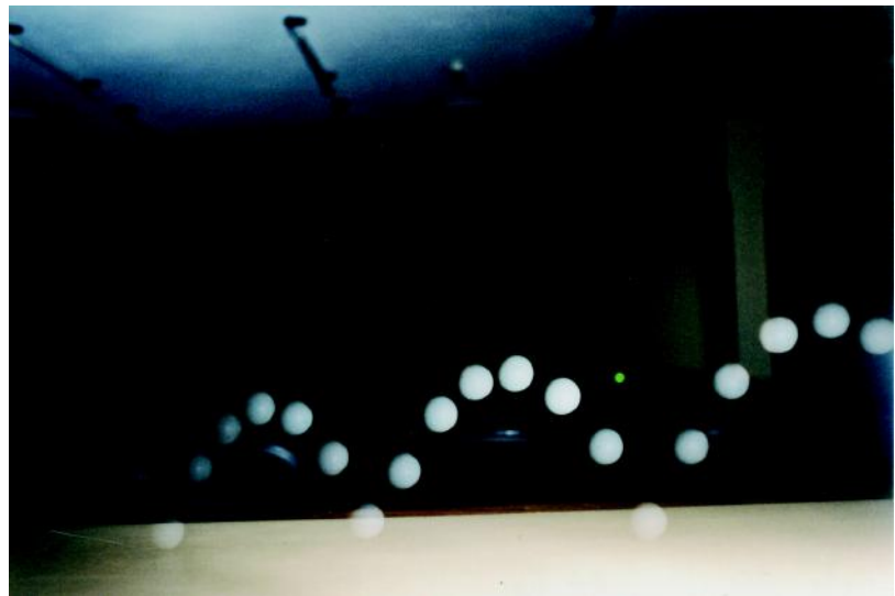
Figura 3. Fotografia estroboscópica (20 Hz) de uma bolinha de ping-pong pingando.
