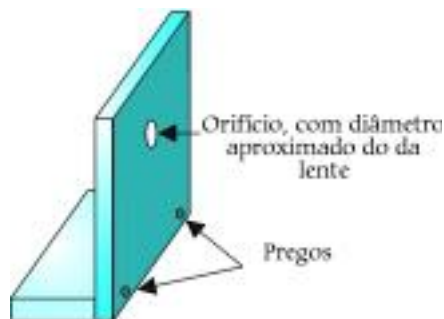
Figura 3. Caso uma lente ocular de 15 X não esteja disponível, a própria lente colimadora do laser de diodo pode ser usada. Um suporte como o da figura pode ser confeccionado em madeira. O orifício com a lente e o laser devem ser montados na mesma altura.
