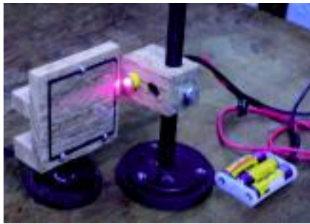
Figura 2. O laser, sem a lente colimadora, foi provido de uma alimentação externa (três pilhas AA). O “espelho” é uma lâmina de vidro, cuja borda foi revestida com uma tira estreita de fita isolante. Uma lente (ocular de 15 X ou a própria lente colimadora do laser) é colocada a 80 cm de distância, apontando para o laser.
