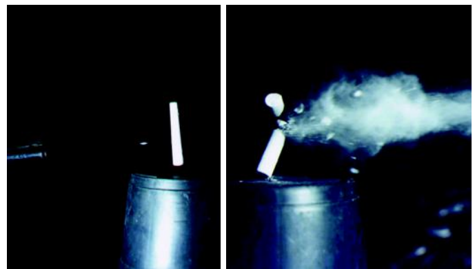
A clássica foto do disparo em um pedaço de giz (que pode ser substituída por uma carta de baralho), obtida através da técnica apresentada.
