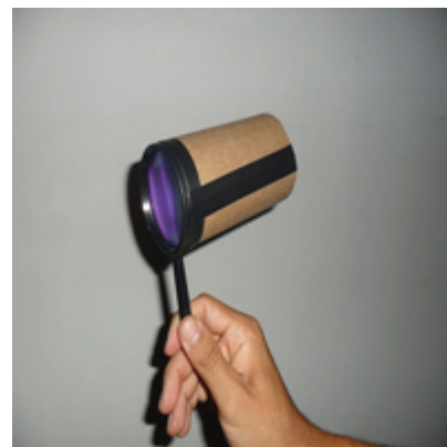
Figura 8 - Cilindro I feito de papel duplex fixado à lupa.
