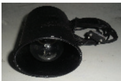
Figura 6 - Fonte típica para banco óptico utilizando lâmpada incandescente.
