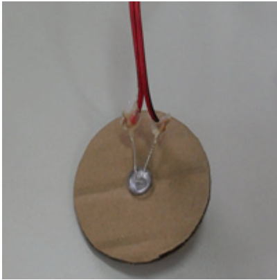
Figura 10 - Disco de papelão com LED fixado.
