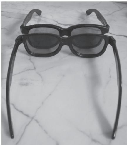
Figura 10 – Superposição de polarizadores com orientação oposta.
