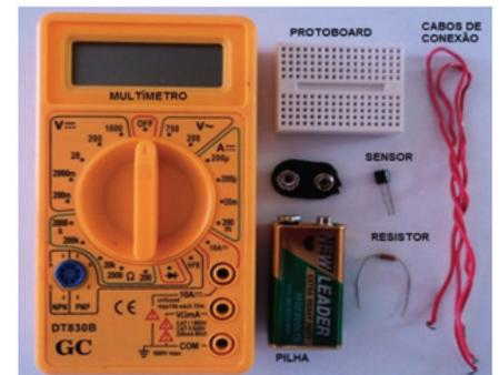
Figura 1 – Materiais necessários para a construção do termômetro.
