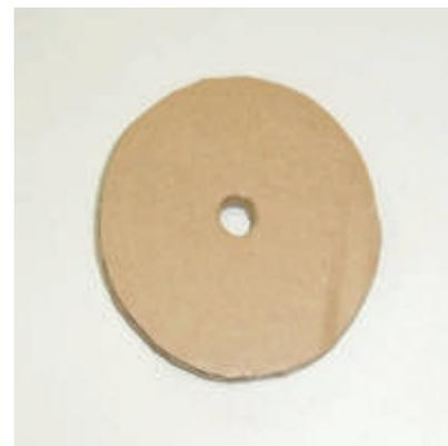
Figura 9 - Disco de papelão com orifício central.
