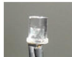
Figura 19 - LED com a extremidade plana.
