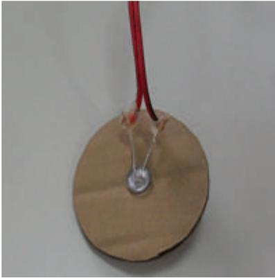
Figura 10 - Disco de papelão com LED fixado.
