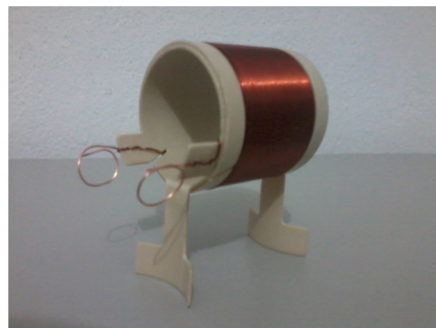
Figura 11: Arranjo final da bobina de cano PVC.
