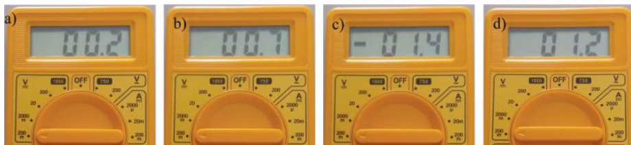
Figura 14: Registro dos valores da f.e.m. produzida pela variação das linhas de campo magnético na bobina (a, b, c e d).
