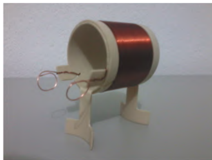
Figura 11: Arranjo final da bobina de cano PVC.
