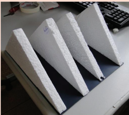
Figura 17: Cortes de isopor colados ao fundo do espelho para garantir o ângulo de 45°.
