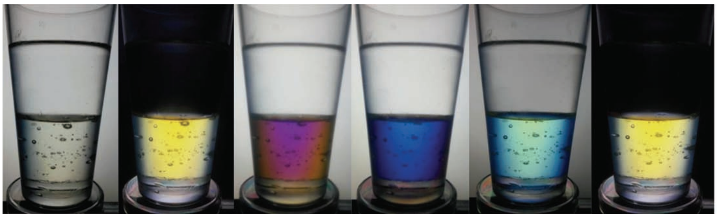
(a) imagem sem o segundo polarizador. (b) o segundo polarizador cruzado com o monitor. (c) o segundo polarizador girando. (d) o segundo polarizador girando. (e) o segundo polarizador girando. (f) o segundo polarizador girando.
