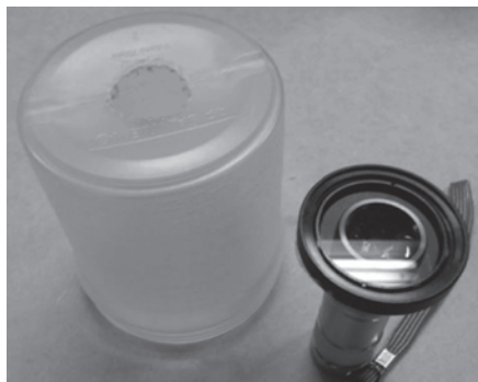
Figura 5: Sugestão de base com lanterna LED, polarizador e pote (com um orifício na base). O polarizador está sobre a lanterna, e o pote deve ser posto sobre eles.
