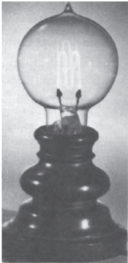
Figura 3: Lâmpada original com filamento de carbono fabricado pelo processo de carbonização de condutores inventado por Lewis H. Latimer em 1882.
