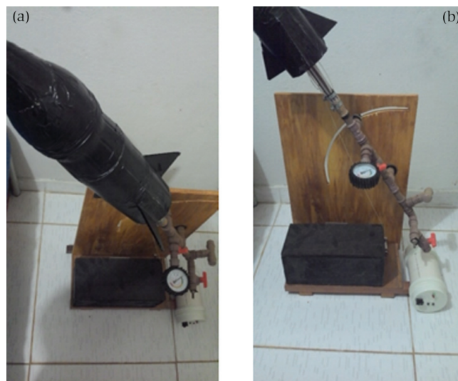
Figura 12: Base de lançamento com um foguete pronto para o lançamento. (a) Vista superior; (b) vista lateral.
