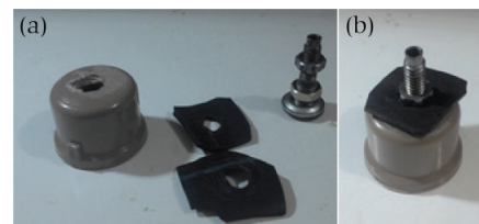
Figura 3: (a) Seleção das peças utilizadas: cap, parafuso, brocas e câmara de ar; (b) fixação do parafuso ao cap com câmara de ar dentro e fora do cap.
