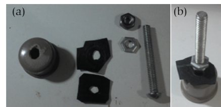
Figura 2: (a) Seleção das peças utilizadas: cap, parafuso, brocas, câmara de ar; (b) fixação do parafuso ao cap com câmara de ar dentro e fora do cap.
