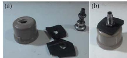
Figura 3: (a) Seleção das peças utilizadas: cap, parafuso, brocas e câmara de ar; (b) fixação do parafuso ao cap com câmara de ar dentro e fora do cap.
