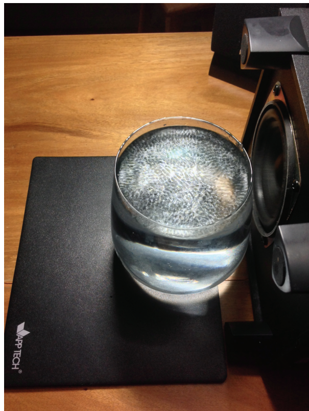
Figura 13: Vibração da água devido à ressonância das paredes de vidro com o som emitido pelo alto-falante. Experimento realizado em casa com equipamentos do dia a dia.
