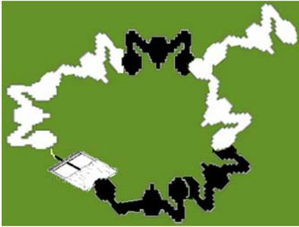
Figura 12: Representação de um circuito elétrico formado por pessoas e uma garrafa de Leiden; a pessoa que está por fora do circuito, apesar de estar em contato, não participa do caminho de passagem da corrente elétrica.
