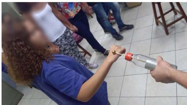
Figura 11: Momento da descarga elétrica a partir da garrafa de Leiden.
