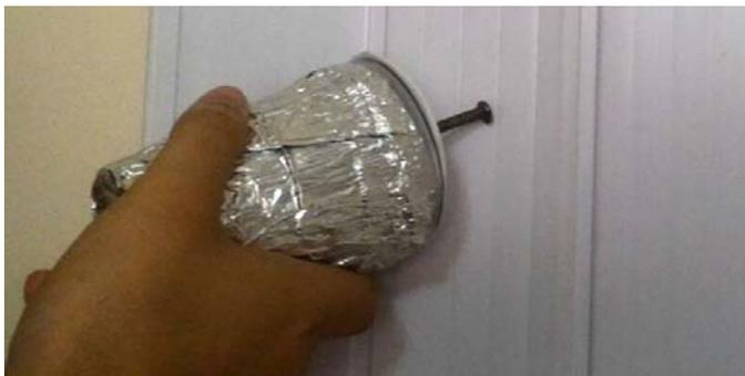
Figura 16: Processo de carregamento da garrafa de Leiden em uma placa de PVC eletrizada.
