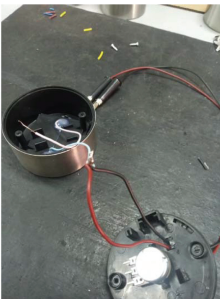
Figura 11: Conexão dos cabos elétricos ao polo negativo da célula fotovoltaica.
