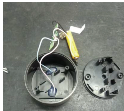
Figura 8: Retirada dos componentes eletrônicos e preparação dos fios da célula.
