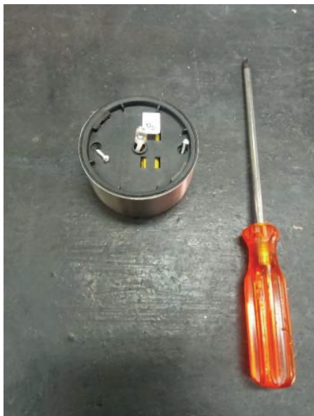
Figura 7: Retirada da tampa traseira da célula.
