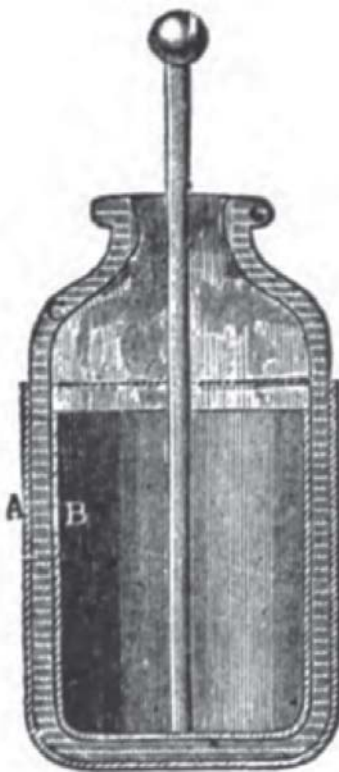
Figura 4: Típica configuração de uma garrafa de Leiden, com seus dois revestimentos de condutor (A e B), produzida anos mais tarde de sua invenção. Nos modelos iniciais, a garrafa era preenchida com água, ligando o fio com o revestimento interno. Fonte: Ref. [10, p. 86].
