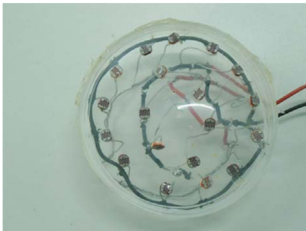
Figura 3: Placa composta de 18 sensores LDR ligados em paralelo para captação de luminosidade.
