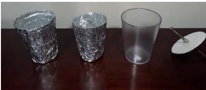
Figura 14: Componentes da garrafa de Leiden desmontável de baixo custo.
