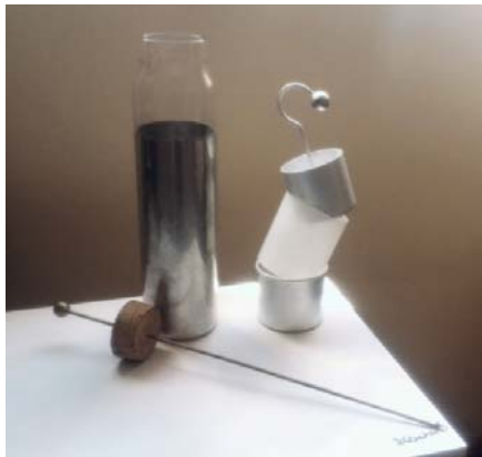
Figura 6: Do lado esquerdo, uma garrafa replicada de acordo com o método da replicação [2]; à direita, os componentes de uma garrafa de Leiden didática desmontável.
