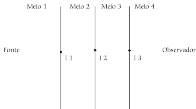
Figura 4: Caso em que há meios de propagação diferentes separando fonte e observador. As interfaces são marcadas por I1, I2 e I3.
