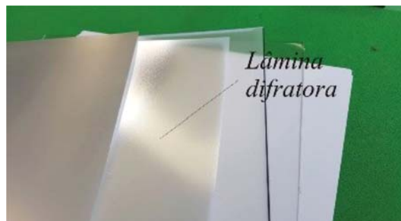
Figura 4: A figura mostra a folha difratora encontrada no monitor de LCD.
