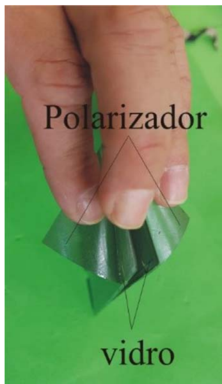
Figura 2: A figura mostra as duas camadas de polarizadores aderidos ao vidro do LCD.
