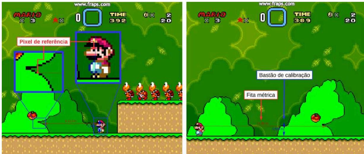
Figura 2 - Definição dos pixels de referência no programa Tracker (imagem da esquerda) para medição da posição horizontal instantânea com a fita métrica (imagem da direita). O bastão de calibração foi definido com a altura do personagem.
