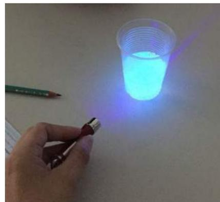
Figura 4 - Incidência de luz negra na água tônica.
