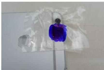
Figura 1 - Adaptação da lanterna do celular para luz semelhante à luz negra da lanterna.
