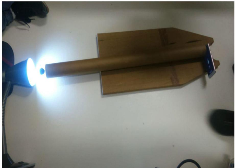
Figura 3 - Arranjo experimental para a determinação do raio do exoplaneta durante o trânsito. À esquerda da figura vemos a lâmpada e o exoplaneta, enquanto, à direita, observamos o smartphone.
