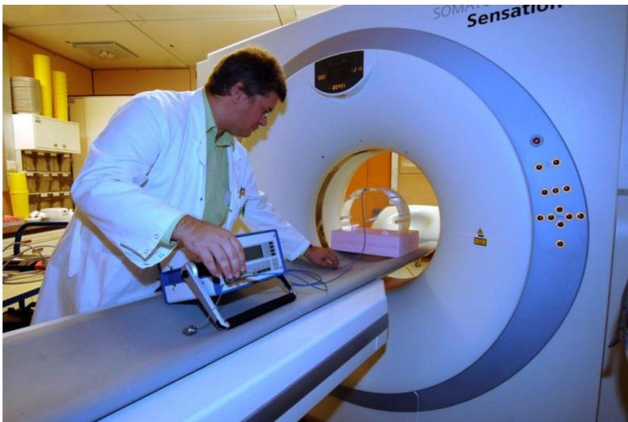
Figura 3 - Um físico médico fazendo medições com detector e simulador cilíndrico num tomógrafo clínico<sup>iv</sup>.
