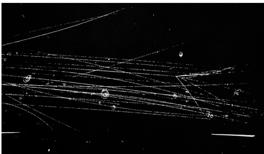
Figura 6 - Foto de uma câmara de bolhas de hidrogênio de 20 polegadas, mostrando aproximadamente 15 mésons pi entrando em um feixe paralelo pela esquerda - apresentada pelo Departamento Americano de Energia (US Department of Energy). 10
