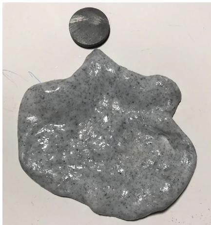
Figura 3 - Geleca magnética finalizada. Note que, ao aproximarmos um ímã, a geleca se movimenta em direção a este, devido à atração entre o ímã e o metal contido na substância.
