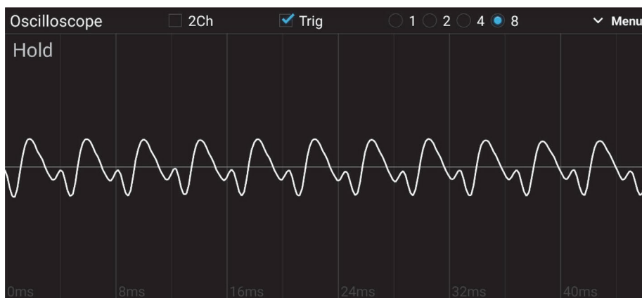
Figura 7 - Espectro de sinal lido pelo osciloscópio para a segunda corda (Si) do violão.
