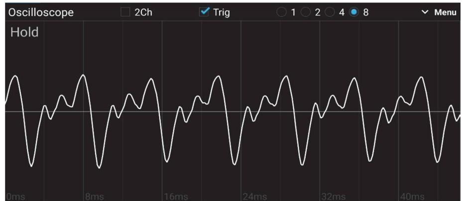
Figura 9 - Sinal elétrico referente à quarta corda do violão (Ré); a frequência do sinal calculada foi de 144,8 Hz.
