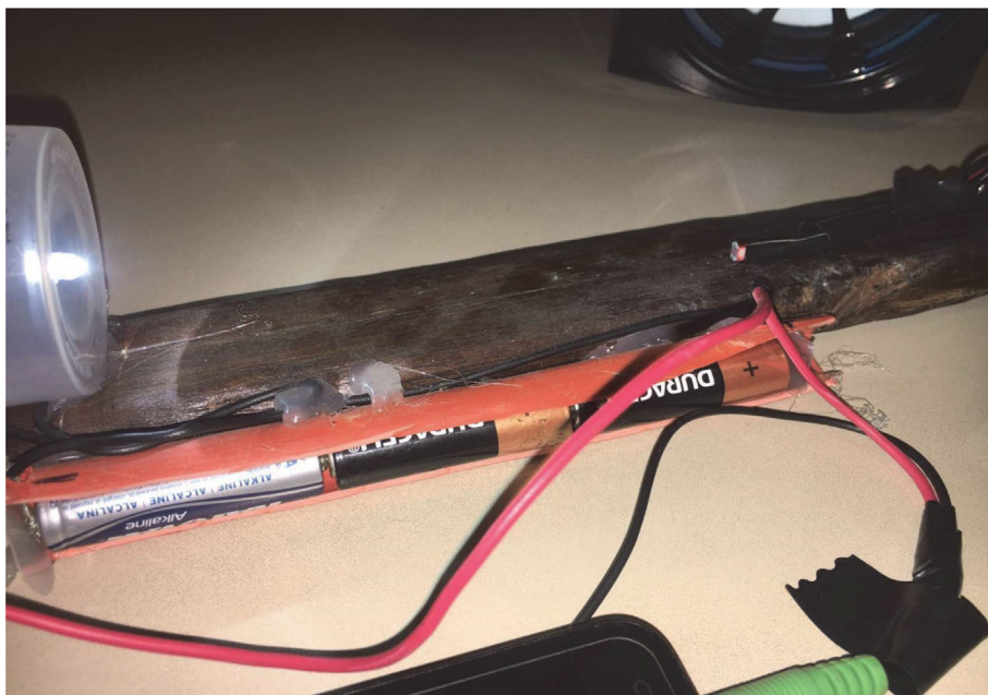
Figura 3 - Imagem mais próxima do circuito, onde podemos ver as pilhas ligadas em série, bem como o LDR à direita.
