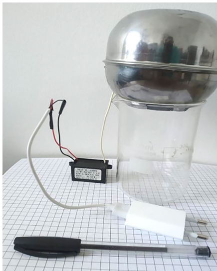
Figura 4 - Aparato experimental do gerador eletrostático de baixo custo.
