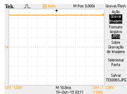
Figura 10 - Sinal de tensão contínuo de 3,3 VDC da saída da placa Arduino Uno rev. 3 mostrada no display do osciloscópio.
