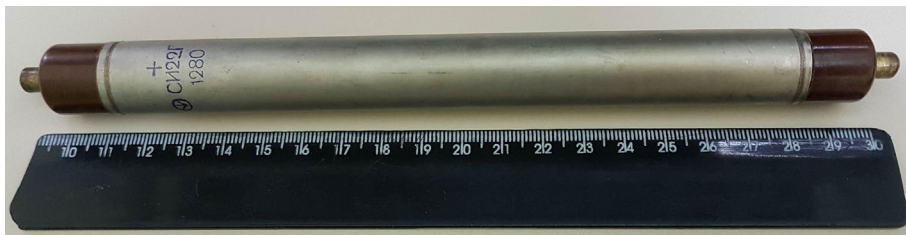
Figura 1 - Tubo SI-22G do tipo Geiger-Muller usado como sensor de radiação ionizante.
