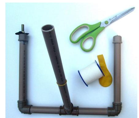
Figura 1 - Em (a), a configuração para a montagem da base. Em (b), a base montada; o ângulo do cano de 25 cm com a horizontal deve ser de 45°.
