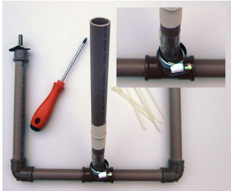
Figura 4 - Abraçadeiras de nylon cortadas com 10 cm de comprimento. Fita adesiva e braçadeira de metal na base do cano de 25 cm. Na parte superior da figura, encontra-se a braçadeira de metal ampliada.
