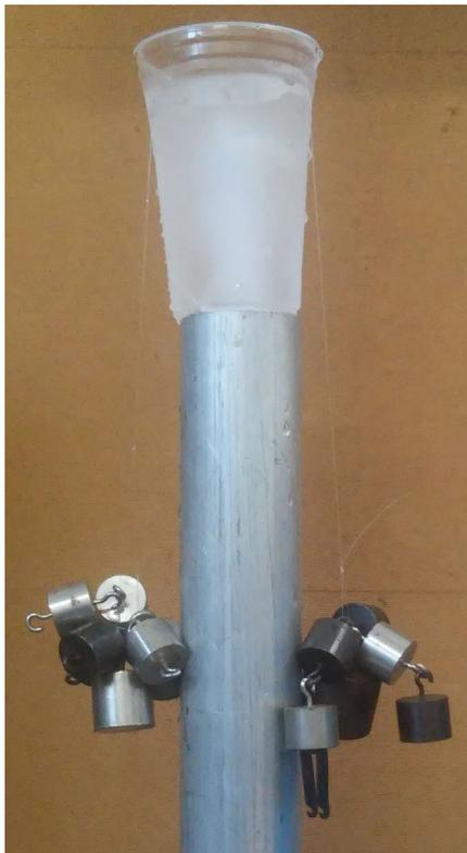
Figura 2 - Montagem experimental do estudo sobre regelo.
