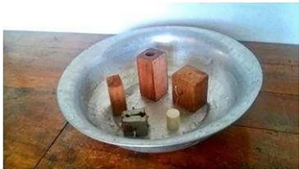
Figura 6 - Bacia, bloco de madeira maciço, bloco de madeira maciço preso a um fio, bloco de madeira com um cilindro oco, cilindro de cerâmica, peça de metal.
