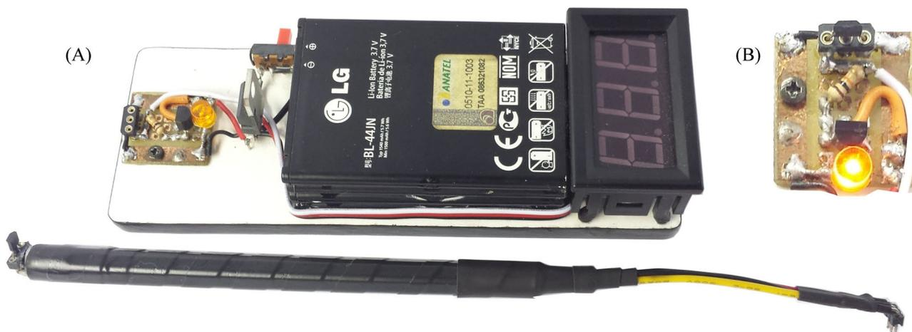
Figura 3 - (A) equipamento montado com a extensão do sensor desconectada ao lado. (B) Imagem ampliada do circuito elétrico.
