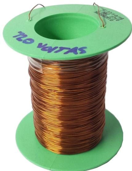
Figura 4 - Solenoide com 720 voltas usado no experimento.
