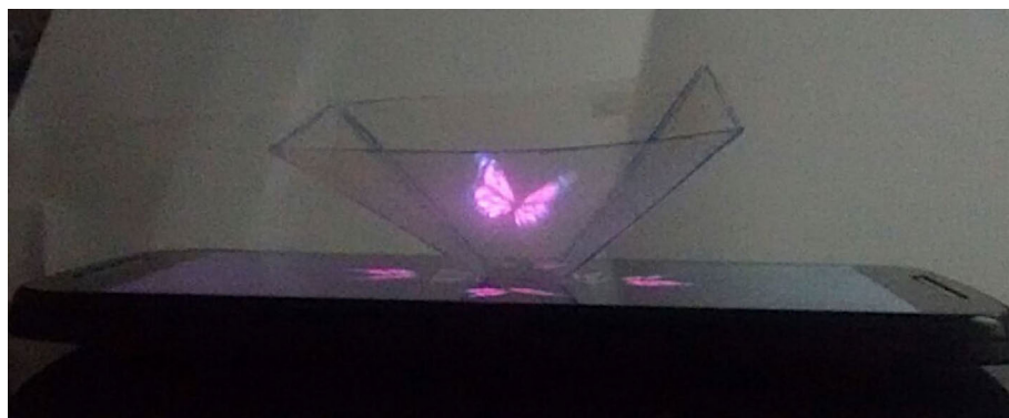
Figura 5 - Pirâmide quadrangular “holográfica” para uso em smartphones e tablets. Fonte: Ref. [2, p. e-2506-6].
