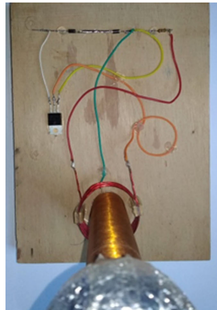
Figura 9 - Base da mini bobina com o circuito resultante.
